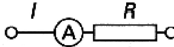
L'intensité se mesure à l'aide d'un ampèremètre toujours placé en série dans le circuit.
