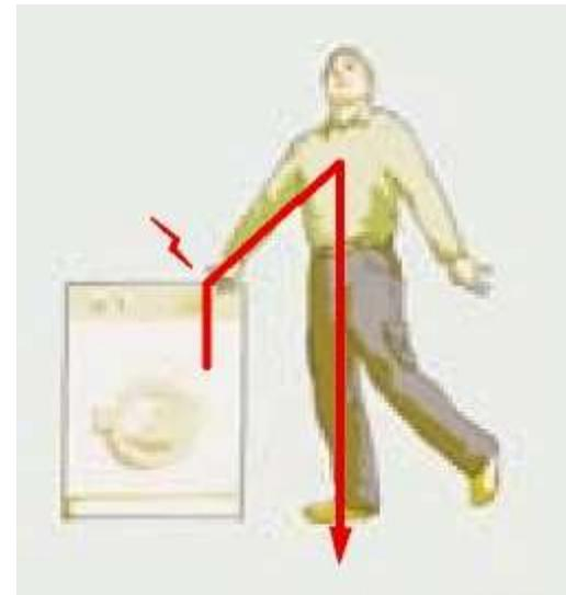
*Le contact indirect est particulièrement sournois, car rien ne laisse prévoir la présence de tension sur une partie métallique normalement hors tension.*
