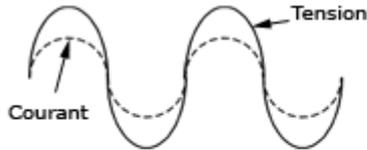
**Cas 1 :** Courant et tension en phase et sinusoïdaux
