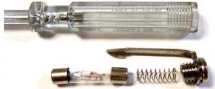
L'électricien dispose d'un **tournevis testeur**, qui inclut une lampe témoin lui permettant de détecter la présence de tension entre 100 et 500 Volts sur un point de circuit d'une installation. La résistance dans le tournevis vaut environ  $670\,000\ \Omega$ , au contact de la phase, un courant très faible traverse alors la lampe et passe dans le sol en circulant dans le corps.
