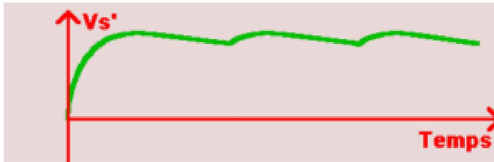
Le condensateur va stabiliser la tension; les légères variations de tension que l'on observe sont dues à la charge à la décharge du condensateur.
