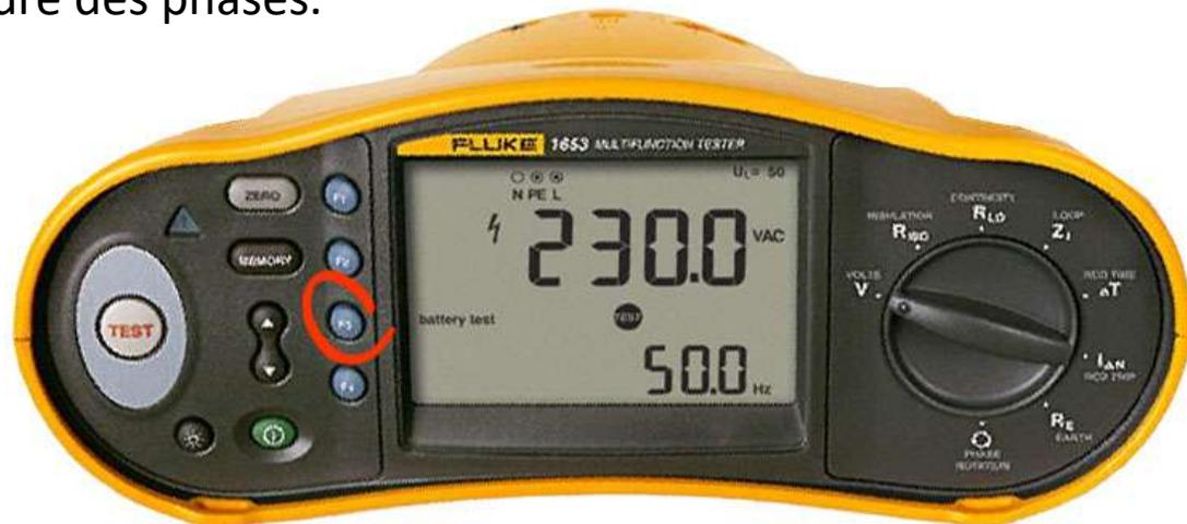
*Testeur d'installation électrique*
