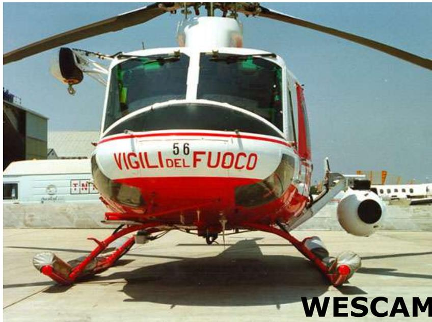
Cette boule offre trois axes de mouvement :  $360^\circ$  continu en Pan,  $90^\circ$  en Tilt, et  $30^\circ$  en Roll, chacun étant gyrostatique, et permet l'utilisation jusqu'à de très longues focales (jusqu'au 250 mm en film 35 mm). Depuis peu un quatrième gyroscope a été installé afin de mieux stabiliser le magasin et de compenser le déséquilibre lié au déroulement/enroulement des bobines
